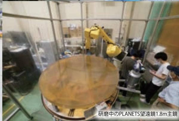
研磨中のPLANETS望遠鏡1.8m主鏡
