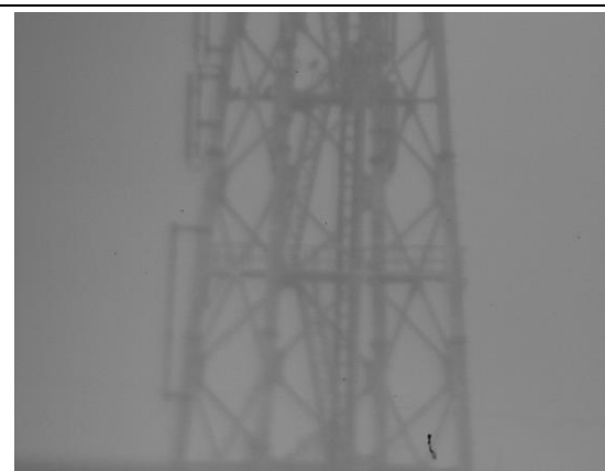
図 2. 試作光学系で捉えた約 1km 先の鉄塔の画像 (細かい構造は分解能 0.1^\circ 以上に相当)
