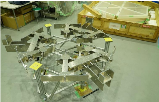
図 1: 製作した 36 点支持 Whiffletree 主鏡支持機構
